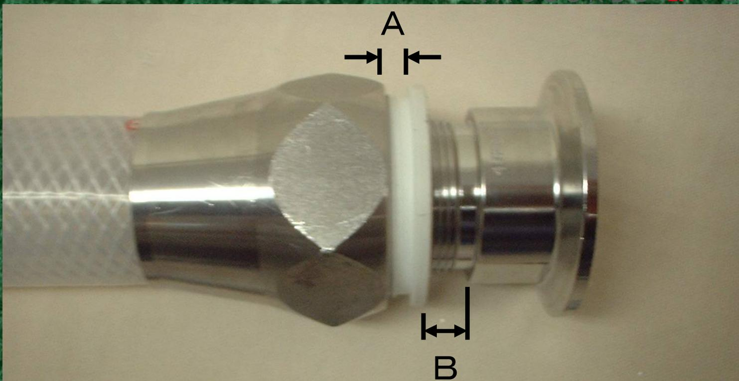
白いアダプターをネジをかじらないようにアウターにねじ込みます。アダプターがホースに当たってもまだ少し隙間がある程度がベストです。もし、隙間がなくなってしまうたら、インナーを抜いてホースを少し出して再度インナーを差し込みます。ホースの最終的な長さは露出しているインナーのネジ部の長さ(B)だけ短くなります。
