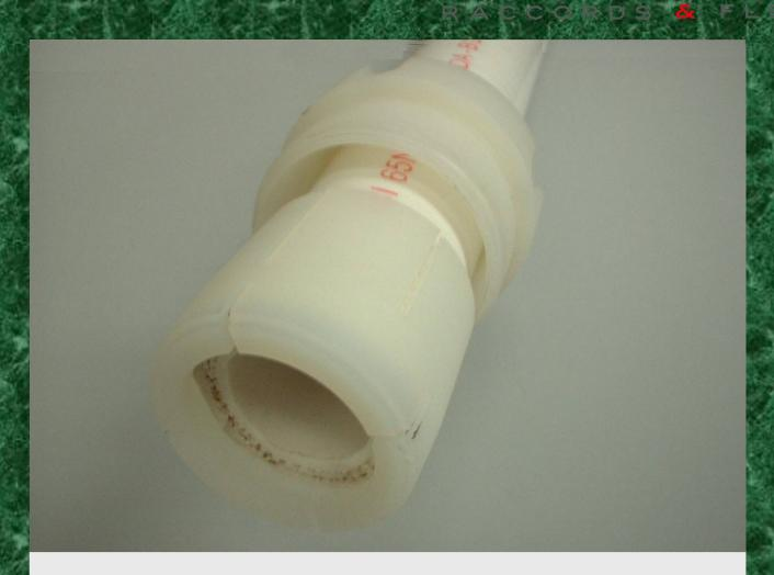
さらにインナーにホースを差し込みます。このときインナーはホースの先端部よりさらに10mm程度飛び出ます。
