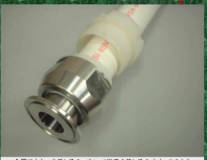
金属アウターを差し込み、次いで継手を差し込みます。このとき 継手のOーリングとインナーの先端が重なるようにして下さい。 専用工具で締め込みます。
