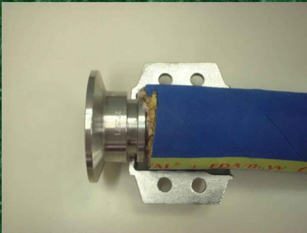
継手の溝にクランプの爪が
